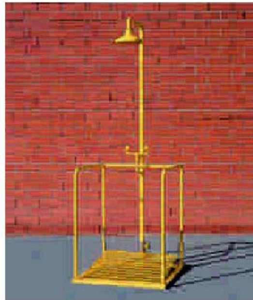
AB004720 DUSCHSTATION MIT KÖRPER-UND AUGENDUSCHE. AUSLÖSUNG ERFOLGT DURCH BETRETEN DER PLATTFORM; ZUR AUFSTELLUNG IM FREIEN GEEIGNET. DUSCHKOPF AUS ABS-KUNSTSTOFF
